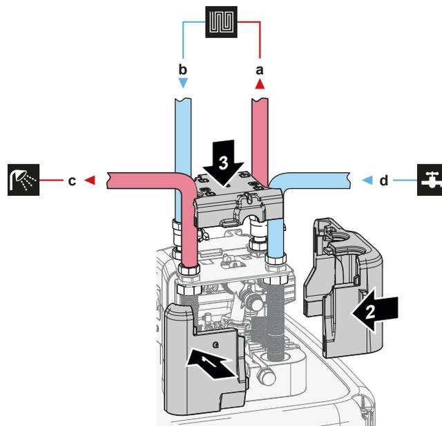
8 Установите следующие компоненты (приобретаются на месте) на входе холодной воды в резервуар ГВБП:
