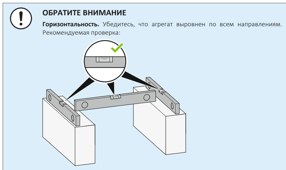
Используйте 4 комплекта анкерных болтов М12, гаек и шайб. Предусмотрите под агрегатом свободное пространство как минимум 150 мм. Кроме того, убедитесь, что агрегат устанавливается как минимум на 100 мм выше максимального ожидаемого уровня снежного покрова.
