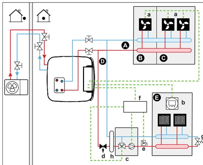
3 Система с гидравлическим сепаратором для обеих зон:
