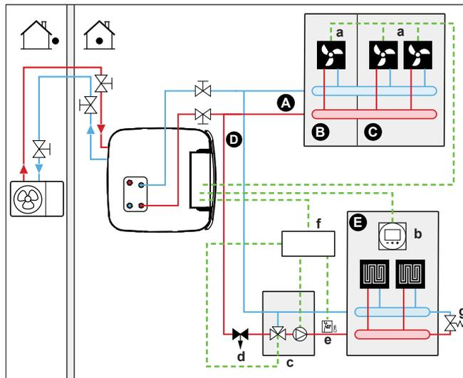
2 Система с гидравлическим сепаратором для основной зоны:
