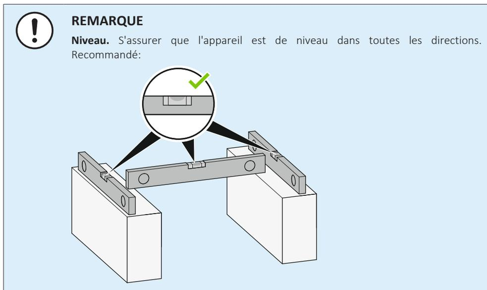
Utilisez 4 jeux de boulons d'ancrage M12, d'écrous et de rondelles. Laissez un espace libre d'au moins 150 mm sous l'unité. Veillez également à ce que l'unité soit positionnée au moins 100 mm au-dessus du niveau maximum de neige envisagé.
