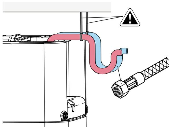
**7** Installez l'isolation thermique du bloc hydraulique.
