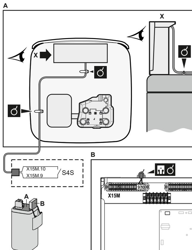
5 Raccordez le câblage haute tension de la manière suivante:
