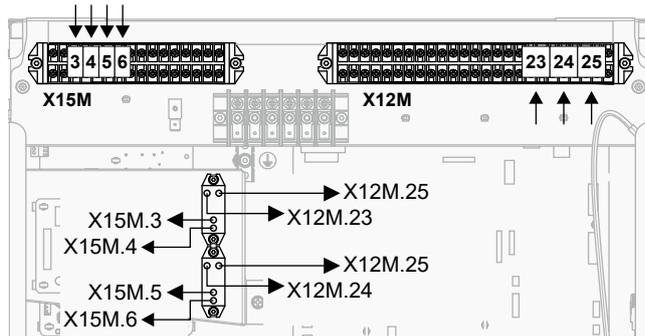
4 Raccordez le câblage basse tension de la manière suivante:
