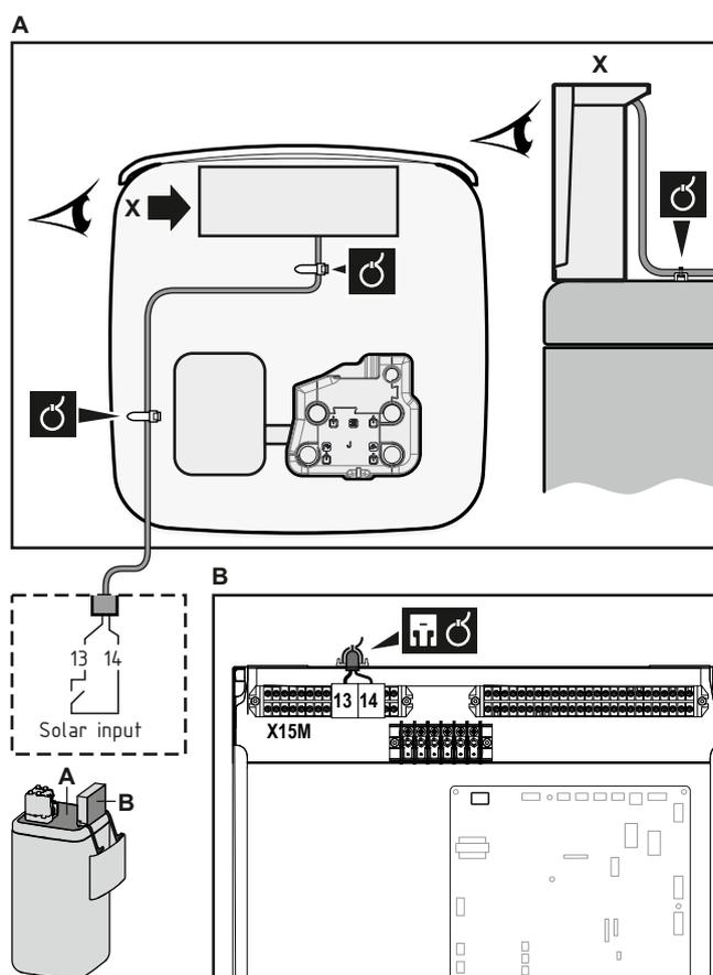
3 Fixez le câble avec les attache-câbles sur les supports d'attaches. Informations générales, voir "9.3.1 Raccordement du câblage électrique à l'unité intérieure" [▶ 125].
