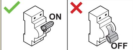
Per avvisare l'utente, fissare gli adesivi "NON DISATTIVARE l'interruttore di protezione" nel quadro elettrico e il più vicino possibile agli interruttori di protezione della pompa di calore. Sull'adesivo, inserire il numero di riferimento dell'interruttore di protezione per garantire la massima chiarezza.
