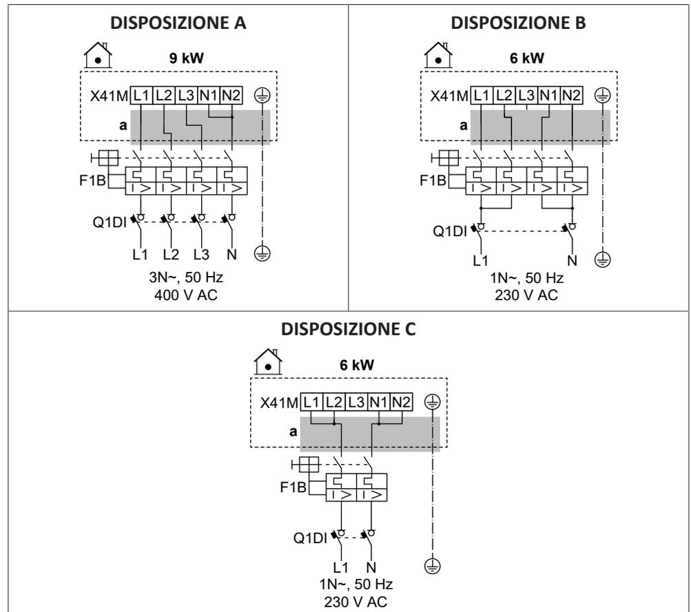
Possibili disposizioni in caso di modelli 4V (riscaldatore di riserva a più livelli da 4,5 kW)
