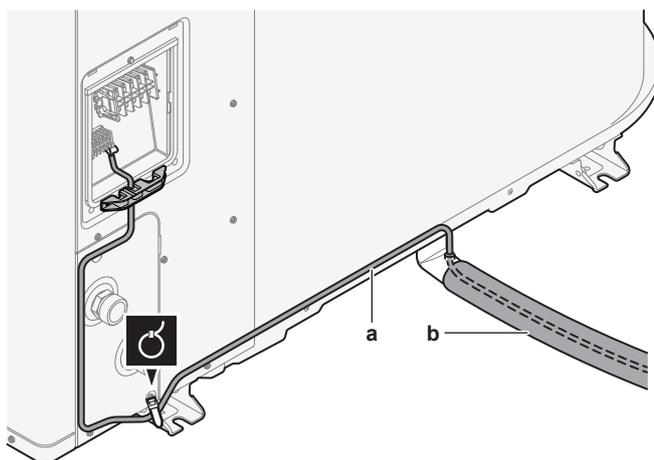
**a** Cavo del riscaldatore del tubo di scarico
