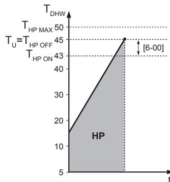
**HP** Pompa di calore. Se il tempo di riscaldamento da parte della pompa di calore è eccessivo, è possibile ricorrere al riscaldamento ausiliario da parte del riscaldatore di riserva
