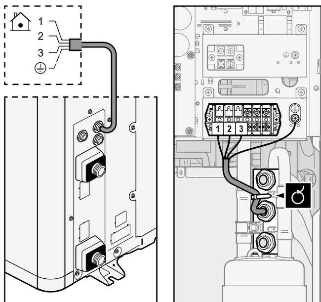
**3 (opzionale) Cavo del riscaldatore del tubo di scarico:**
