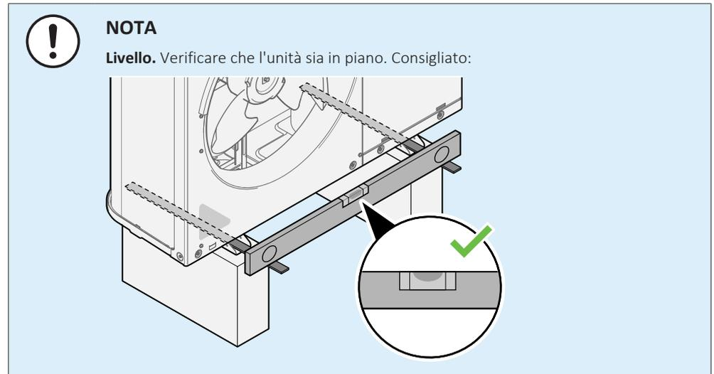
Utilizzare 4 serie di bulloni di ancoraggio M12, dadi e rondelle. Prevedere uno spazio di almeno 150 mm sotto all'unità. Inoltre, assicurarsi che l'unità venga posizionata almeno 100 mm al di sopra dell'altezza massima a cui si prevede possa arrivare la neve caduta.
