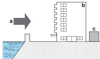
Ist die Außeneinheit direktem Wind vom Meer ausgesetzt, installieren Sie einen Windschutz.
