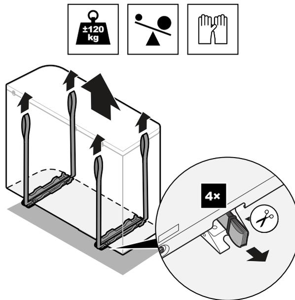
4.2.2 So packen Sie das Außengerät aus
