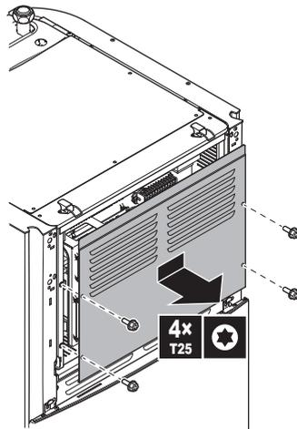
**4** Entfernen Sie bei Bedarf die Frontblende. Das ist zum Beispiel in den folgenden Fällen erforderlich:
