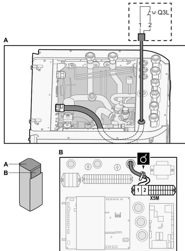
3 Befestigen Sie das Kabel mit Kabelbindern an den Kabelbinderhalterungen.
