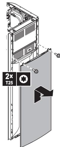
**5** Wenn Sie Zugriff auf die Hochspannungskomponenten benötigen, entfernen Sie die Hochspannungsschaltkasten-Abdeckung.
