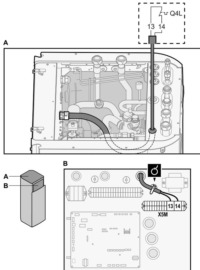
5 Befestigen Sie das Kabel mit Kabelbindern an den Kabelbinderhalterungen.
