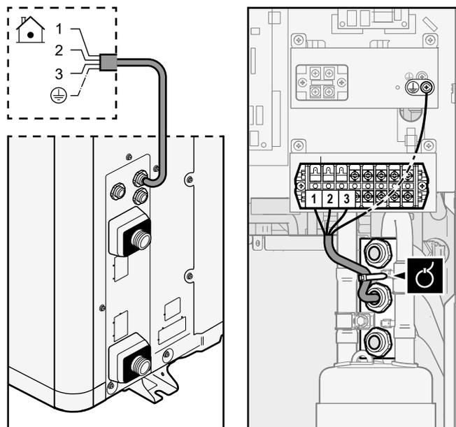
**3 (optional) Ablaufschlauchheizelement-Kabel:**
