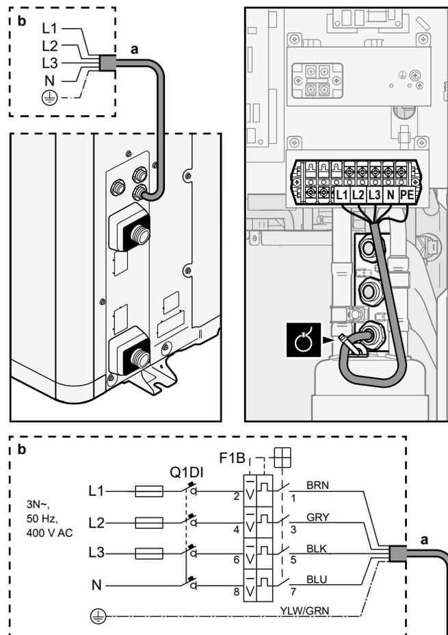
**a** Stromversorgungskabel (bauseitige Bereitstellung)
