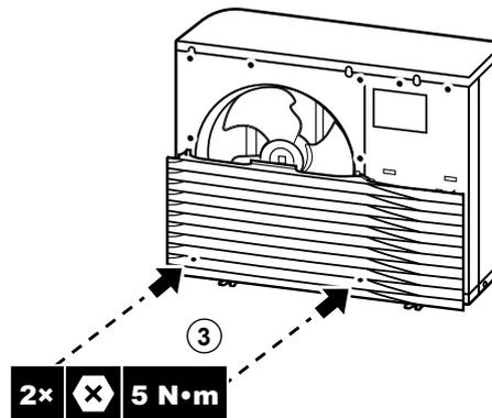
**Installieren Sie den oberen Teil des Auslassgitters**
