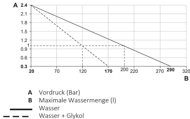
**Beispiel: Maximale Wassermenge und Vordruck des Ausdehnungsgefäßes**
