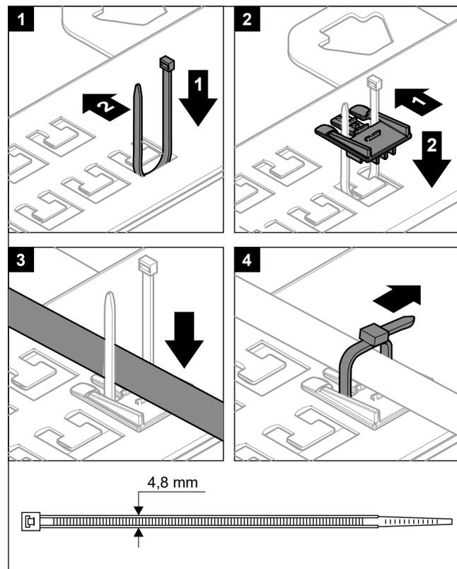
Es ist wichtig, dass sich die Befestigungsplatte der Anschlüsse NICHT in der Wartungsposition befindet, während Kabel an einen der Anschlüsse angeschlossen werden. Andernfalls könnten die Kabel zu kurz sein.
