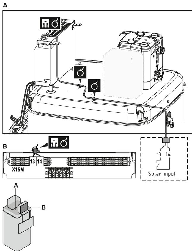
3 Befestigen Sie das Kabel mit Kabelbindern an den Kabelbinderhalterungen. Allgemeine Informationen finden Sie unter "9.3.1 Die elektrischen Leitungen an die Inneneinheiten anschließen" [▶ 138].
