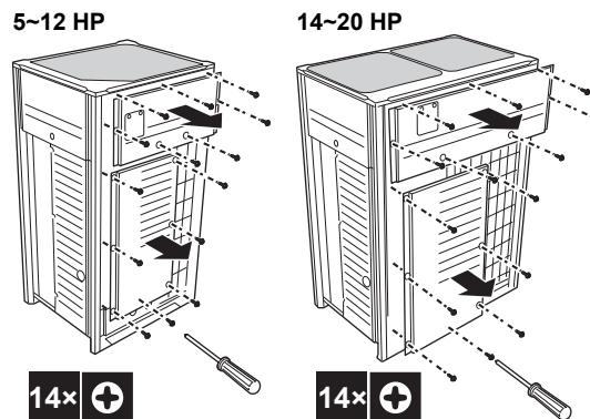
Une fois que les plaques avant sont ouvertes, il est possible d'accéder au coffret électrique. Voir "17.2.3 Pour ouvrir le coffret électrique de l'unité extérieure" [▶ 83].
