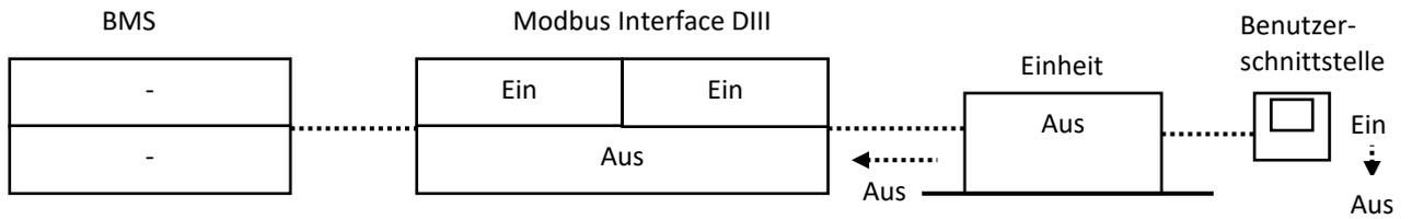
5. Das BMS empfängt den Status des Input-Registers (1) und kopiert den empfangenen Status in die Holding-Register (2).
