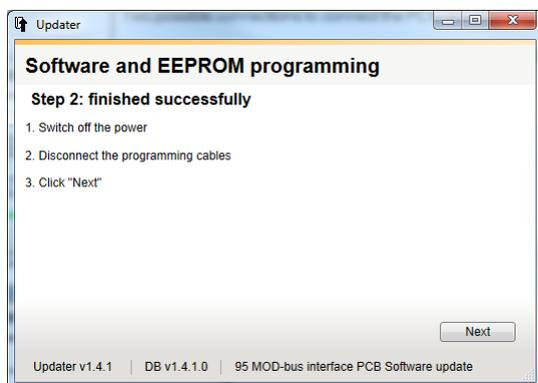
9. Zum Schluss das Gerät ausschalten und alle Kabel trennen.
