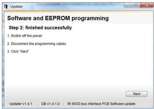
10. Zum Schluss das Gerät ausschalten und alle Kabel trennen.
