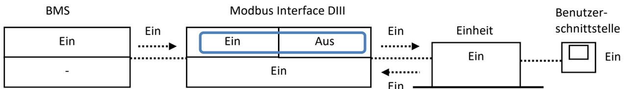
Der Wert im Holding-Register wird geändert. Folglich sendet das Modbus Interface DIII den Befehl zu den Einheiten.
