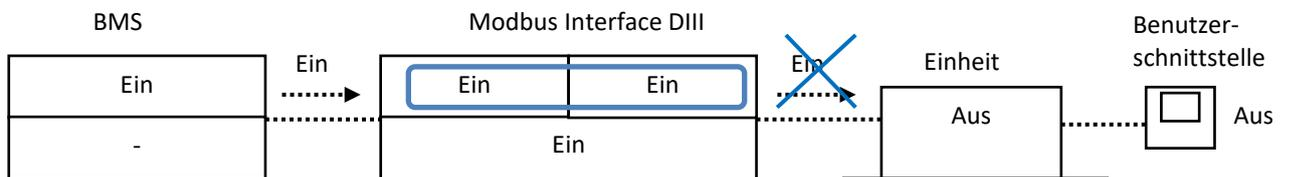
Der Wert im Holding-Register wird nicht geändert. Folglich sendet das Modbus Interface DIII den Befehl nicht zu den Einheiten.
