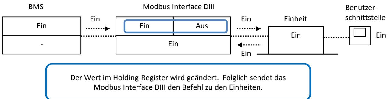
7. Das BMS empfängt den Status des Input-Registers (1) und kopiert den empfangenen Status in die Holding-Register (2).
