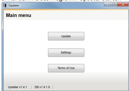
6. Das Menü Settings öffnen und sicherstellen, dass der korrekte serielle USB COM-Port ausgewählt ist (z. B. COM4).
