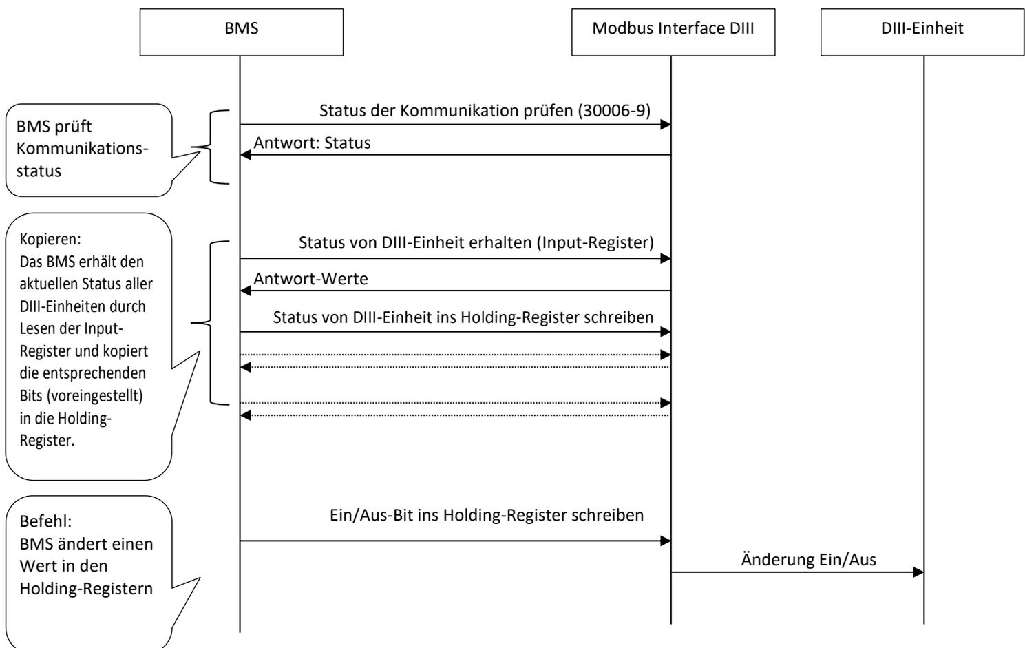
Schritt-für-Schritt-Erklärung der erforderlichen Kopie durch das BMS
