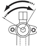
Отвинчивается против часовой стрелки
