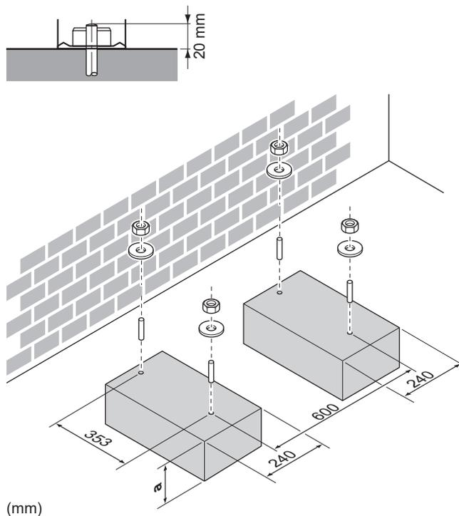
а 100 мм над расчетной поверхностью снежного покрова
