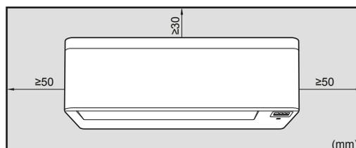
**Nota:** asegúrese de que no haya obstáculos a menos de 500 mm del receptor de señal de infrarrojos. Pueden afectar al rendimiento de recepción del controlador remoto inalámbrico.
