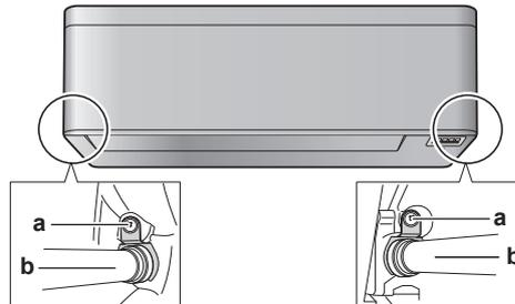
**a** Tornillo de fijación del aislamiento
