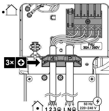
**5** Skrutky svorkovnice dôkladne dotiahnite. Odporúčame použiť skrutkovač Phillips.
